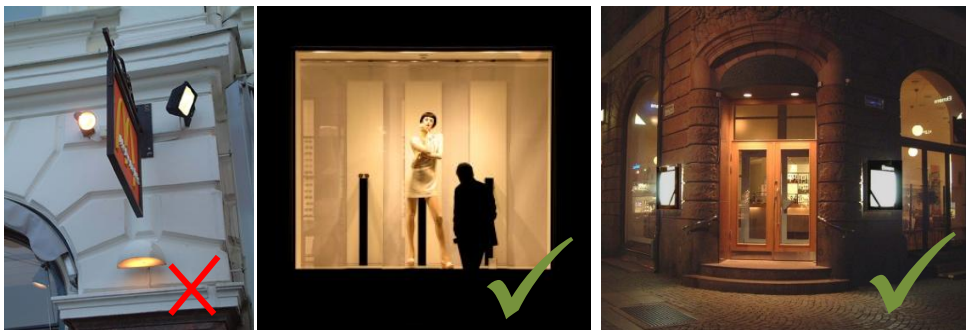
Eksempler på skilte-, indgangs- og butiksbelysning. Første billede viser skiltebelysning med dårligt tilpasset og blændende armaturer. Andet billede viser et udstillingsvindue med en veltilpasset belysning. Tredje billede viser en indbydende indgangsbelysning, som ikke blænder.
